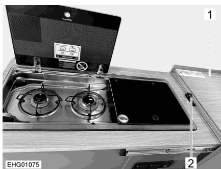
Bild 55 Kochstelle, Arbeitsplatte zur Seite geschoben
