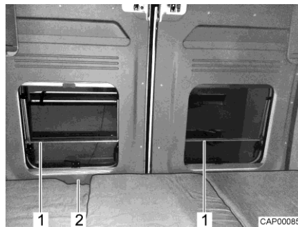
Kuva 40 Putoamissuoja (pitkittäiset takasängyt)
