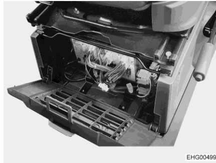
Kuva 65 Asennuspaikka, sähkö- ja elektroniikkayksikkö
