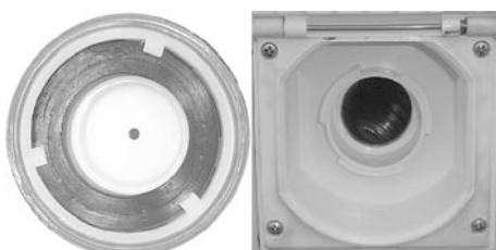
Bild 79: Lock med vridlås (vänster) påfyllningsstuts för färskvatten (höger)
