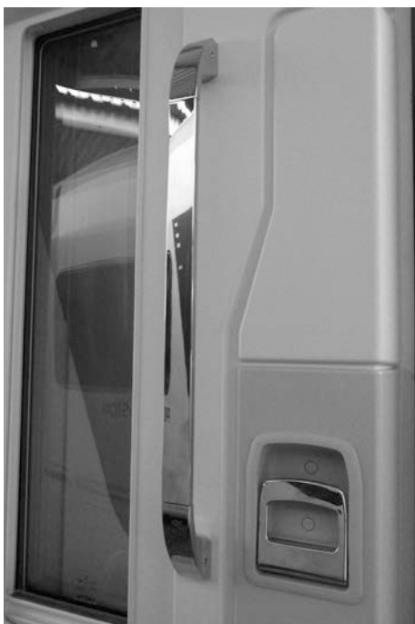
Bild 17 Invändig dörr med greppstång och greppbygel, exempel
