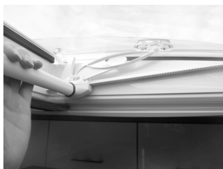
Bild 90: Manövrera takkåpa 400x400 mm / VisionStar 700x500 mm
