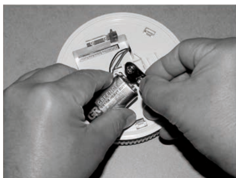
Bild 162: Byte av batteri
