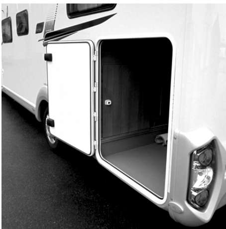
Bild 18: Boendedel, servicefack på utsidan, exempel: Litet förvaringsfack för ofta använda fordons- eller resetillbehör
