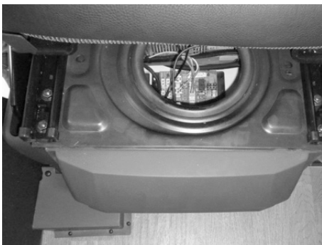
Kuva 7: Liitäntämoduuli kuljettajan istuimen alla
