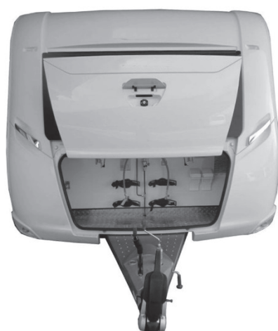
Bild 74: Gasollådans lucka, öppen
