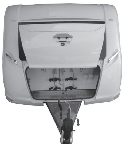
Bild 22: Gasollådans lucka, öppen
