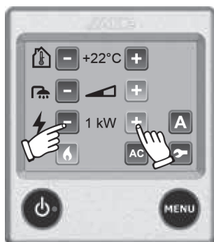
Bild 144: Värma upp med el
