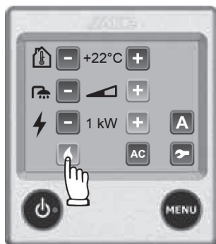
Bild 143: Värma upp med gasol
