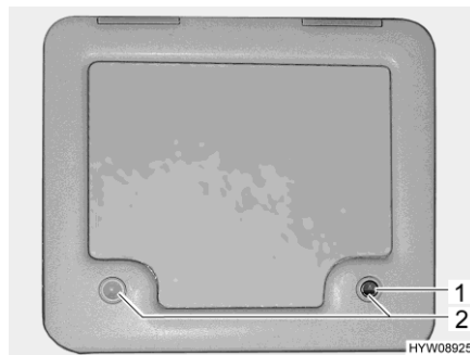
Bild 73 Lucka för latrintanken
