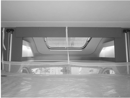
Kuva 127: Laskettu nostovuode ja putoamisenesto
