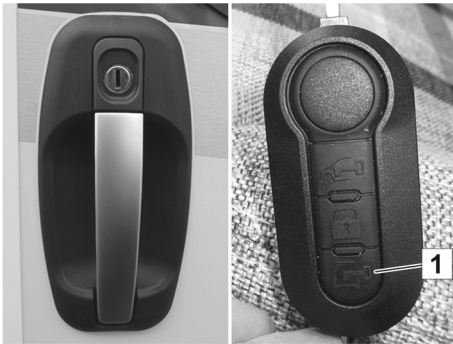
Kuva 10: Ovivipu, avain ja kaukosäädin keskuslukitusta varten
