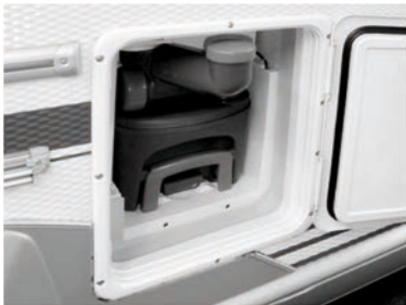
Kuva 47: Jätössäiliö ja huuhteluveden täyttöaukko
