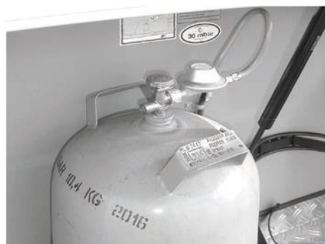
Fig. 68: Bombola di gas con pressostato di bassa pressione e tubo flessibile per bassa pressione
