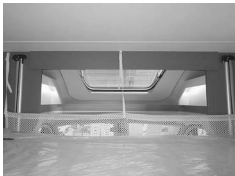
Afb. 167: Neergelaten hefbed met valbescherming
