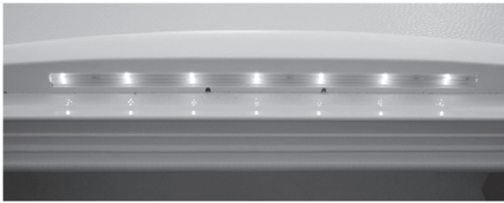
Abb. 68: Vorzeltleuchte mit Leuchtdioden
