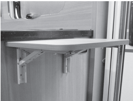
Abb. 187: Klappkonsole zur Verlängerung der Küchenarbeitsplatte
