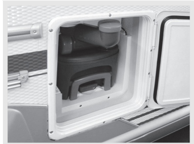
Abb. 50: Fäkalientank mit Spülwasser-Einfüllstutzen
