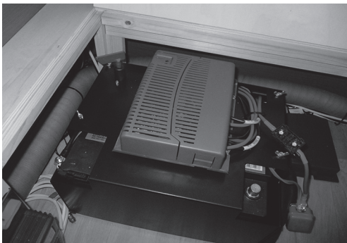
Abb. 63: Batterieabdeckung mit Steuergerät für Mover (optional)
