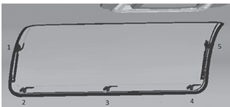
Abb. 28: Innenansicht des gewölbten Ausstellfensters mit fünf Drehriegeln
