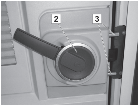
Abb. 17: Tür geschlossen und gesichert
