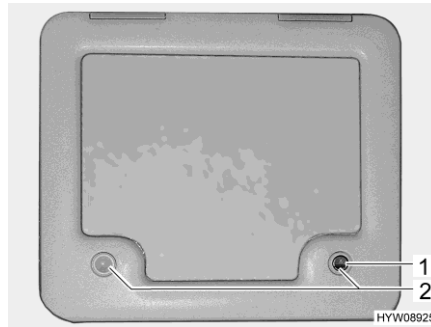
Bild 105 Klappe für den Fäkalientank
