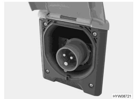
Kuva 69 230 V:n liitäntä ajoneuvolla (CEE-pistorasia)
