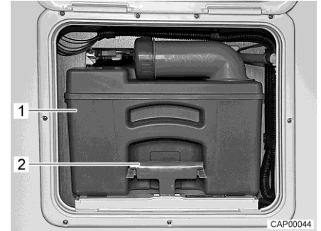
Fig. 106 Réservoir pour matières fécales
