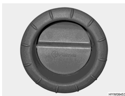
Fig. 79 Buse de sortie d'air (chauffage à air chaud)
