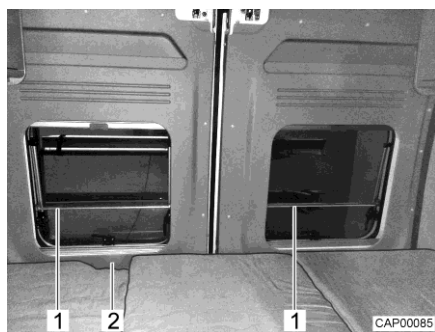
Fig. 40 Protection antichute (lit arrière longitudinal)
