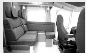
Abb. 11: Umbau der L-Sitzbank in eine Mitfahrsitzbank
