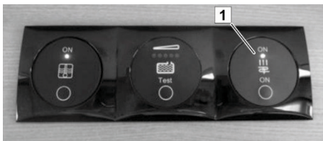
Abb. 90: Ein-/Aus-Schalter der Fußbodentemperierung
