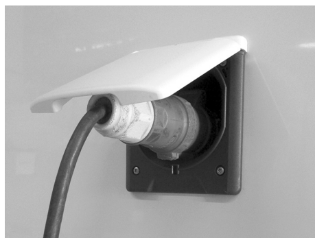
Fig. 57: Allacciamento alla rete elettrica
