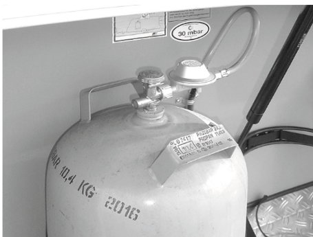
Fig. 71: Bombola di gas con pressostato di bassa pressione e tubo flessibile per bassa pressione
