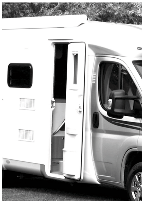
Fig. 15: Cellula abitativa, porta di ingresso
