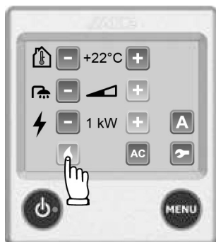
Fig. 149: Riscaldamento a gas
