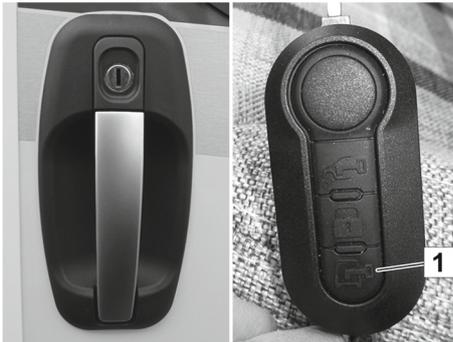
Abb. 12: Türhebel, Schlüssel mit Fernbedienung für die Zentralverriegelung
