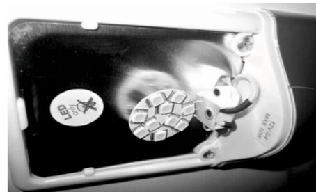
Abb. 143: LED-Leuchtmittel einsetzen
