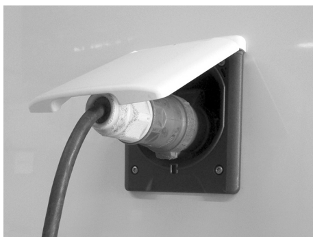
Fig. 51: Allacciamento alla rete elettrica
