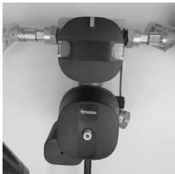
Fig. 71: Alimentazione del gas (con resistenza "Eis-Ex" e indicatore a distanza)
