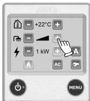
Fig. 161: Più acqua calda
