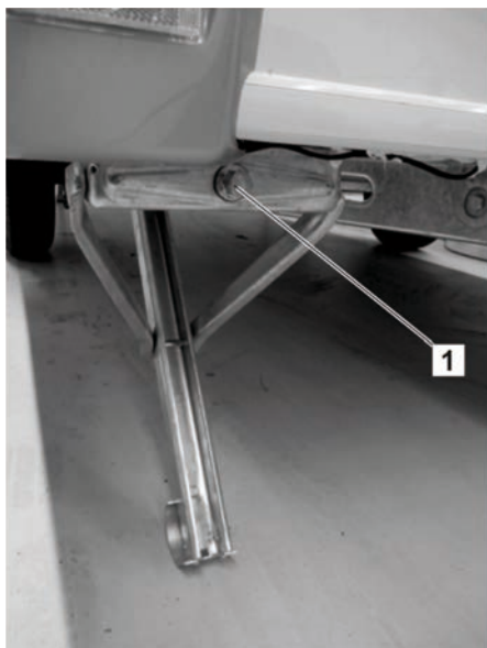
Fig. 10: Esagono (1) per chiave a tubo
