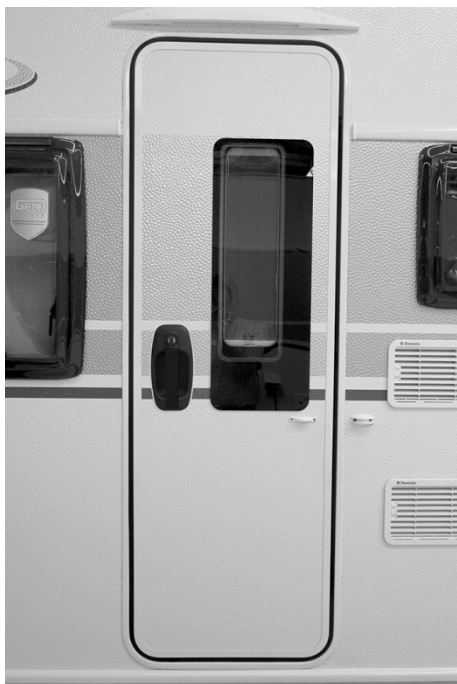
Fig. 12: Porta di ingresso con finestra (esempio)
