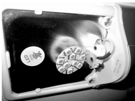
Fig. 222: Sostituire i corpi illuminanti a LED
