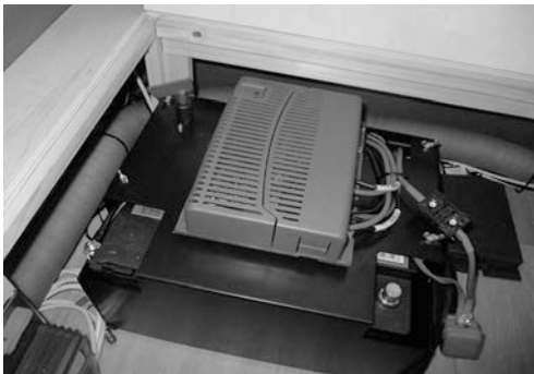
Fig. 60: Copertura batteria con centralina per Mover (optional)
