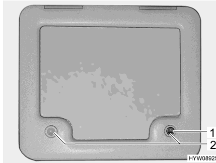
Bild 105 Klappe für den Fäkalientank
