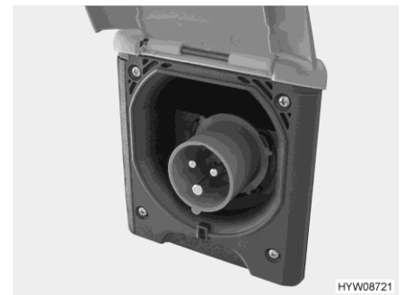
Kuva 69 230 V:n liitäntä ajoneuvolla (CEE-pistorasia)
