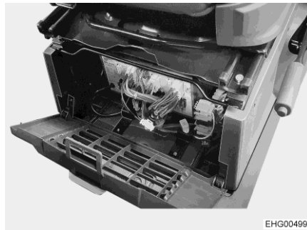
Kuva 65 Asennuspaikka, sähkö- ja elektroniikkayksikkö
