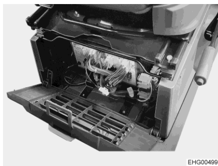
Fig. 65 Ubicazione centralina elettrica
