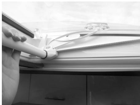
Abb. 122: Dachhaube 400x400 mm / VisionStar 700x500 mm bedienen
