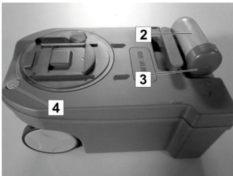
Abb. 192: Fäkalientank entleeren
