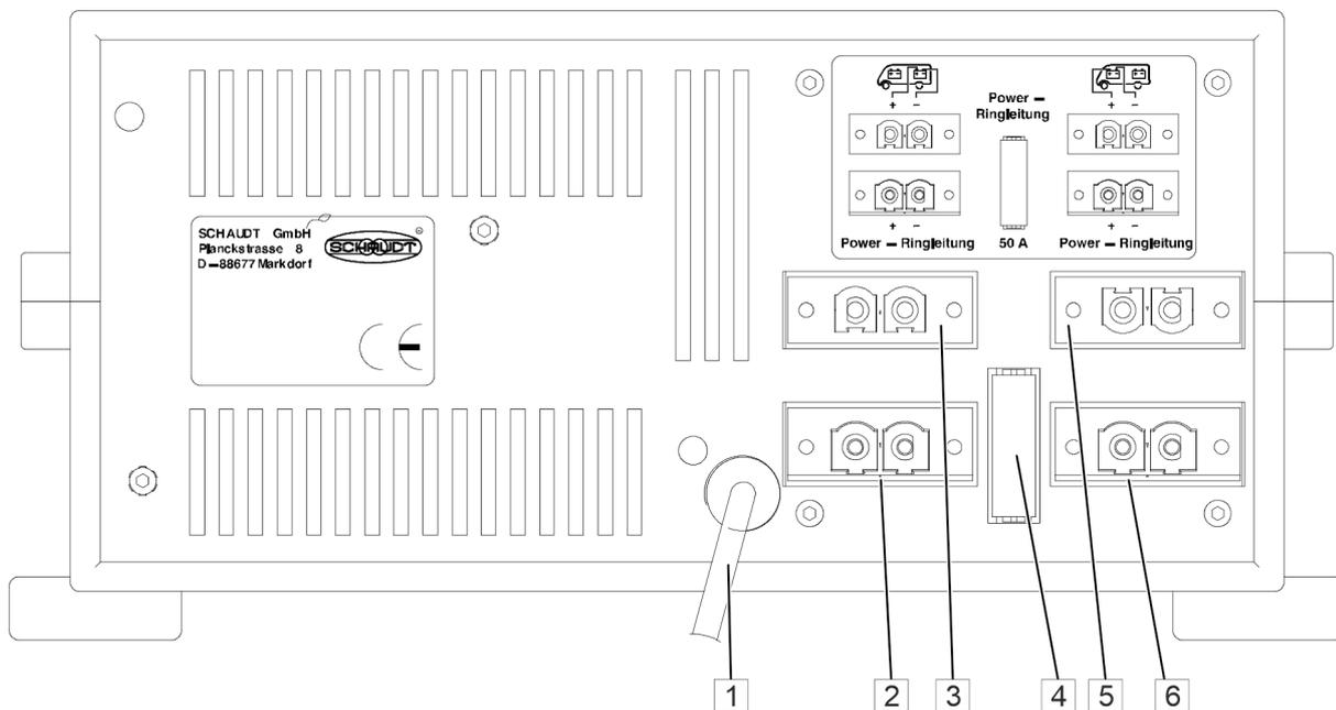
Abb. 6: Anordnung der Sicherungssteckplätze am EBL 400 A (Rückseite)
