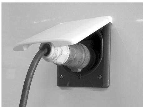
Abb. 64: Elektrischer Netzanschluss
