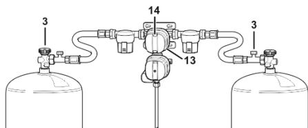
Abb. 116: Gasdruckregler-Set
