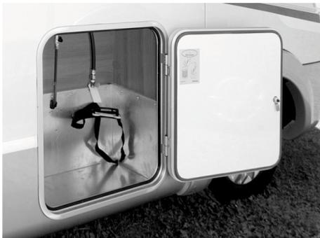
Abb. 78: Gaskasten, Beispiel
