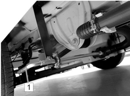
Abb. 110: Gestänge für Ablassventil
