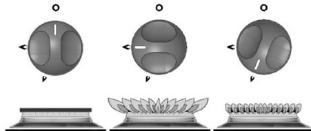
Abb. 195: Stellungen der Bedienelemente: AUS, Hochflamme, Sparflamme
