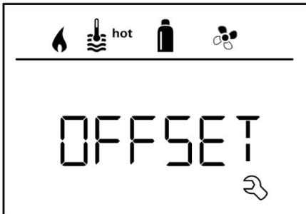
Der Raumtemperaturfühler der angeschlossenen Heizung kann individuell an die Einbausituation des Fühlers angepasst werden. Die Einstellung ist in Schritten von 0,5 °C im Bereich von 0 °C bis -5 °C möglich.
