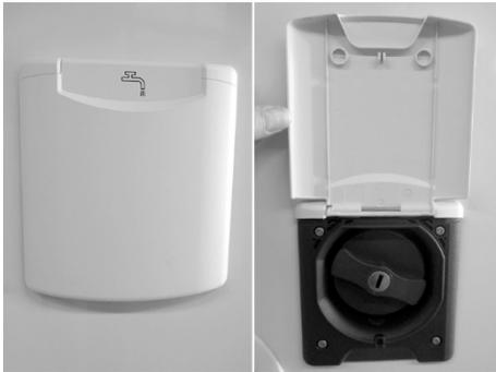
Abb. 101: Frischwasser-Einfüllstutzen
