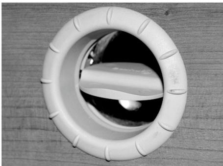
Zum Beheizen des Wohnaufbaus fördert das Gebläse der Gasheizung Warmluft durch das Warmluftrohrsystem und die Warmluftdüsen in den Innenraum.
