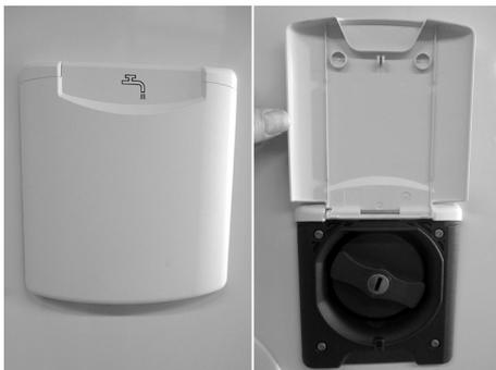
Abb. 105: Frischwasser-Einfüllstutzen
