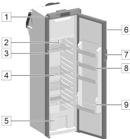
Abb. 200: 12 V-Kompressor-Kühlschrank
