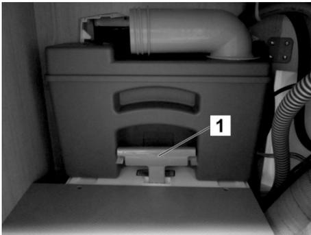
Abb. 191: Fäkalientank im Entsorgungsschacht
