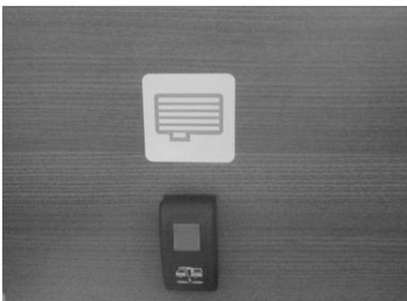
Abb. 111: Kippschalter Ablassventil
