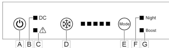
Abb. 201: Bedienelemente 12 V-Kompressor-Kühlschrank
