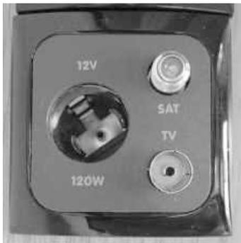
Bei verbauter TV-Wandhalterung wird auch eine 12-V-Steckdose eingerichtet für den wechselseitigen Betrieb des TV-Geräts.
