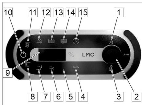
Abb. 65: Bedien- und Kontrollpanel LT 632
