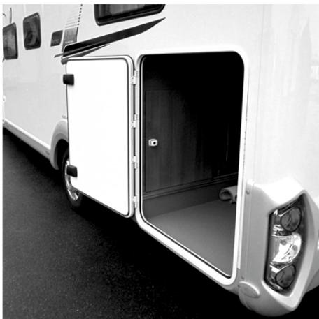
An den Außenseiten des Motorcaravans sind – je nach Modell und gewählter Ausstattung – Klappen für verschiedene Servicefächer angeordnet, z. B. Zugänge für Heckgarage/Heckstauraum, Warmwasserboiler, zum kleinen Staufach (für Fahrzeugzubehör, Werkzeug, Wagenheber) und für den Fäkalientank der Toilette.
