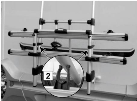
Abb. 33: Fahrradträger hochklappen
