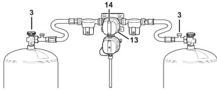
Abb. 118: Gasdruckregler-Set
