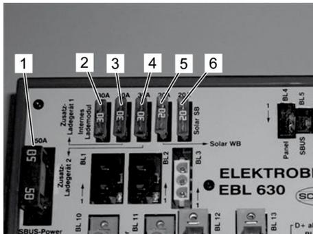
Abb. 5: Anordnung der Sicherungssteckplätze am EBL 630
