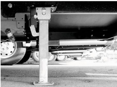
Abb. 21: Heckstütze, ausgefahren
