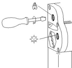
Die Rollospannfedern können mittels Schraubendreher nachgespannt werden.
