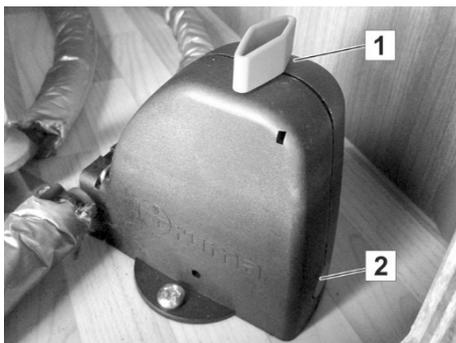
Abb. 167: Sicherheits-Ablassventil geschlossen
