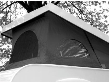
Abb. 183: Aufstelldach, aufgestellt
