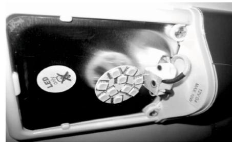
Abb. 206: LED-Leuchtmittel einsetzen
