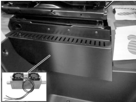
Der ALDE-Turbokonvektor dient zum Beheizen des Fahrerhauses während der Fahrt. Er befindet sich seitlich am Aufbau des Fahrer- und Beifahrersitzes.
