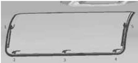
Abb. 38: Innenansicht des gewölbten Ausstellfensters mit fünf Drehriegeln
