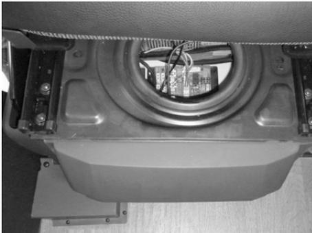
Abb. 9: Schnittstellenmodul unter Fahrersitz
