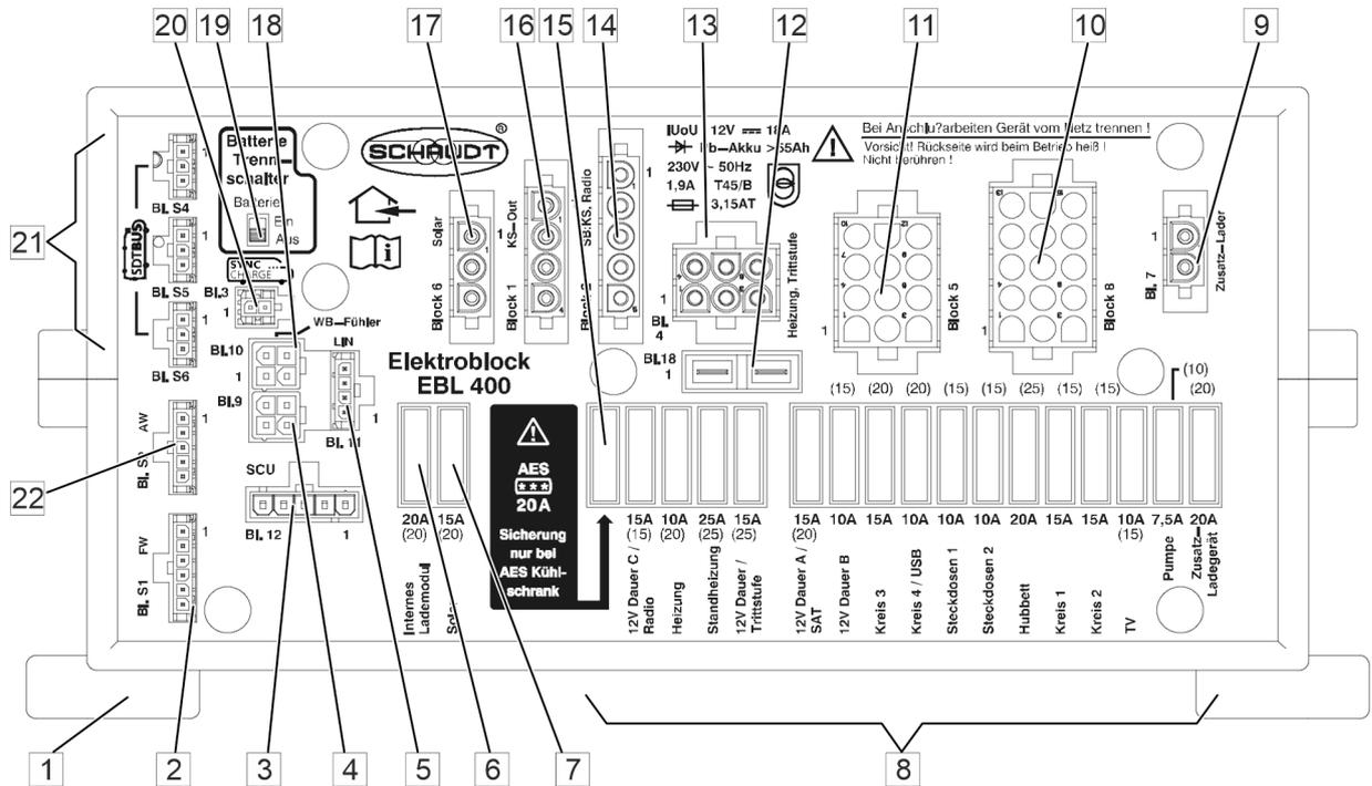
Abb. 7: Anordnung der Sicherungssteckplätze am EBL 400 A (Front)
