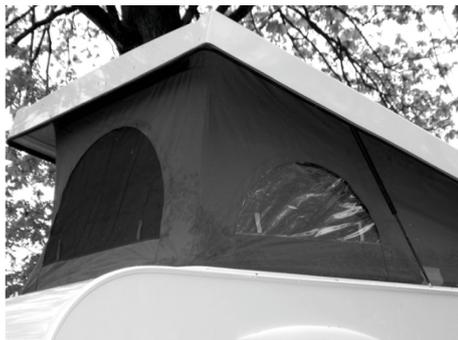
Abb. 45: Aufstelldach, aufgestellt
