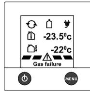
Tritt ein Fehler im Heizungssystem auf, wird die Ursache auf dem Bedienpanel angezeigt.
