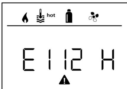
Bei einer Störung springt das Bedienteil Truma CP plus sofort in die Menüebene „Störung“ und zeigt den Fehlercode der Störung an. Mithilfe der Fehlersuchanleitungen kann die Ursache der Störung ermittelt und behoben werden.
