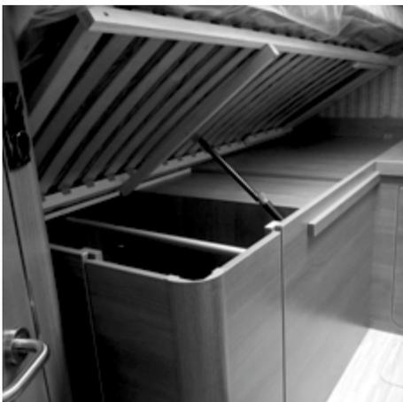
Abb. 51: Gasdruckdämpfer
