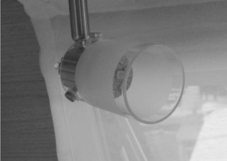
Im Innenbereich befindet sich über der Sitzgruppe und im Schlafbereich ein Beleuchtungs-Schienensystem mit dreh-, schwenk- und versetzbaren 12-V-LED-Strahlern, die für eine gute Ausleuchtung der Plätze sorgen (Handhabung → Abschnitt "Beleuchtung einrichten").
