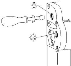
Die Rollospannfedern können mittels Schraubendreher nachgespannt werden.
