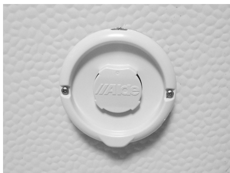
Fig. 91: Conduit d'évacuation des gaz brûlés (sur la paroi)
