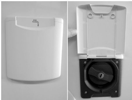
Fig. 101 : Manchon de remplissage d'eau fraîche
