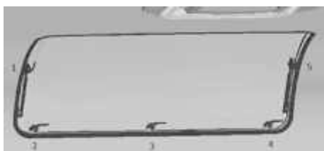
Fig. 38: Vue intérieure de la baie ouvrante galbée à cinq poignées de verrouillage
