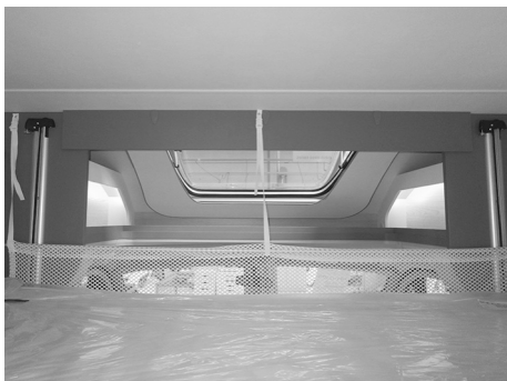
Afb. 181: Neergelaten hefbed met valbescherming
