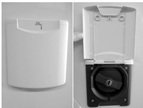
Fig. 23 : Manchon de remplissage d'eau fraîche
