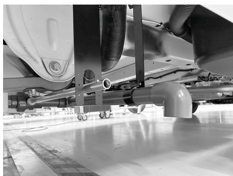
Fig. 84 : Vanne pour eaux grises (exemple)
