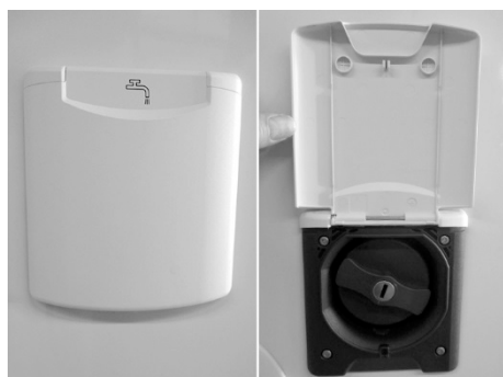
Fig. 76 : Manchon de remplissage d'eau fraîche
