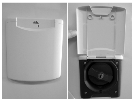
Fig. 79 : Manchon de remplissage d'eau fraîche
