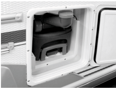
Abb. 52: Fäkalientank mit Spülwasser-Einfüllstutzen
