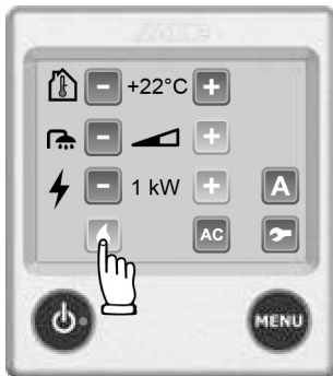
Abb. 144: Heizen mit Gas
