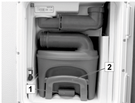
Abb. 172: Fäkalientank im Entsorgungsschacht
