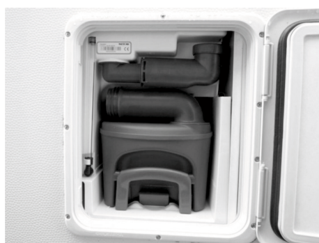
Fig. 64: Serbatoio acque nere con bocchettone di riempimento dell'acqua di risciacquo
