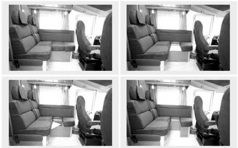
Abb. 11: Umbau der L-Sitzbank in eine Mitfahrersitzbank
