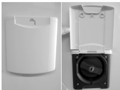
Fig. 70 : Manchon de remplissage d'eau fraîche
