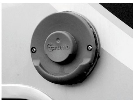
Fig. 68 : Conduit d'évacuation des gaz brûlés (sur la paroi)
