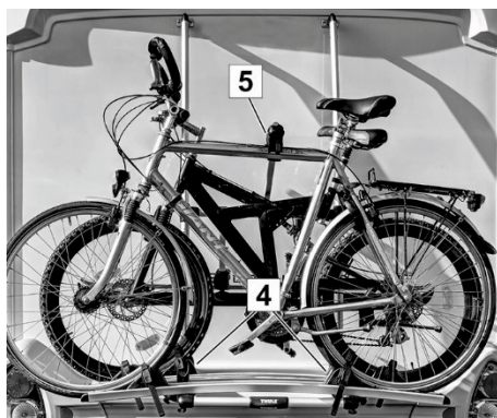
Fig. 28 : Sécuriser les vélos
