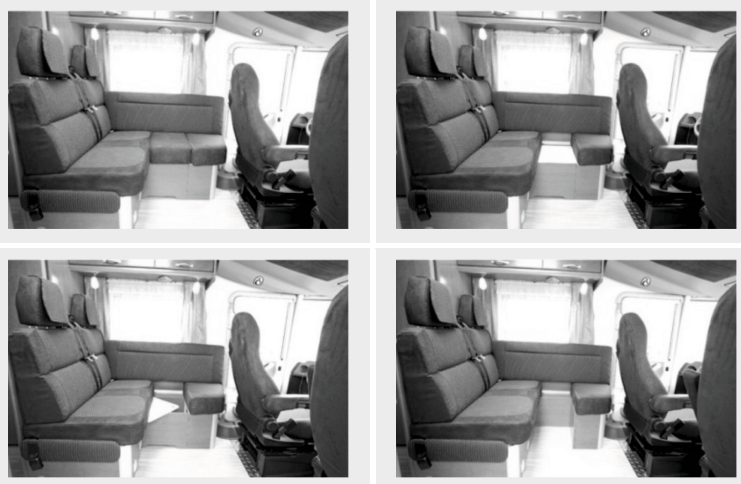
Abb. 12: Umbau der L-Sitzbank in eine Mitfahrsitzbank
