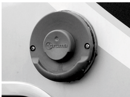
Fig. 81 : Conduit d'évacuation des gaz brûlés (sur la paroi)
