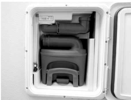
Abb. 64: Fäkalientank mit Spülwasser-Einfüllstutzen
