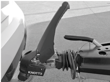
Abb. 9: Zugkugelpkupplung geschlossen, Stabilisierung deaktiviert
