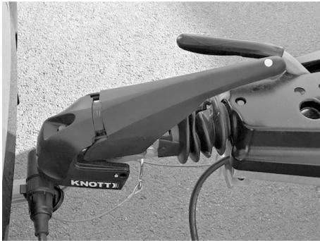
Abb. 10: Zugkugelpkupplung geschlossen, Stabilisierung aktiviert
