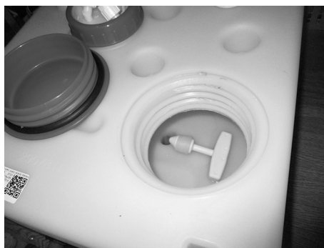
Abb. 101: Ablastsstopfen im Frischwassertank
