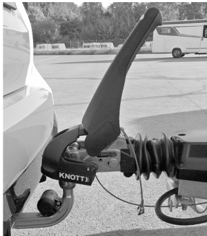
Abb. 13: Zugkugelkupplung geöffnet, Stabilisierung deaktiviert
