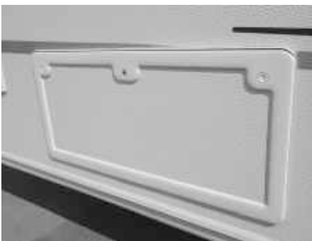
Abb. 34: Wohnaufbau, Servicefach außen
