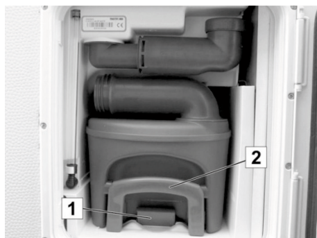
Fig. 192 : Cassette WC dans le puisard d'élimination
