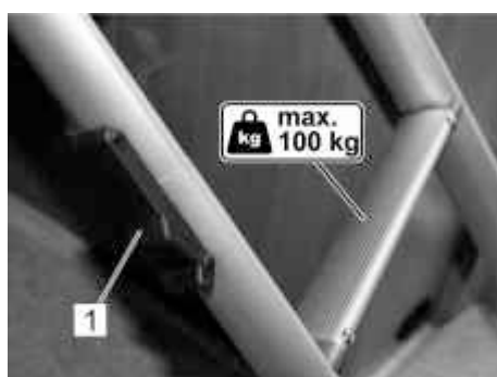
Fig. 152 : Verrouillage (1) de l'échelle d'accès
