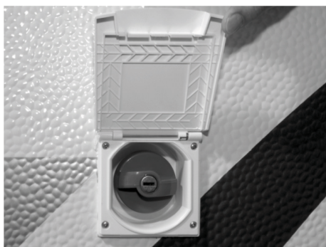
Fig. 97 : Manchon de remplissage d'eau fraîche
