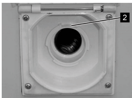
Fig. 107 : manchon de remplissage d'eau fraîche, ouvert
