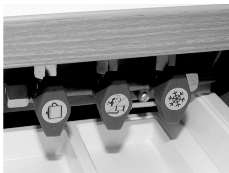
Fig. 91: Vannes d'arrêt rapides
