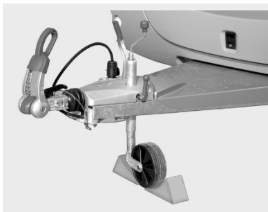
Fig. 173: Sécuriser la roue jockey
