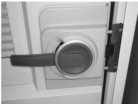
Fig. 25 : Serrure de porte fermée mais non sécurisée
