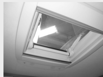
Fig. 22 : Lanterneau 400x400 mm VisionStar 700x500 mm
