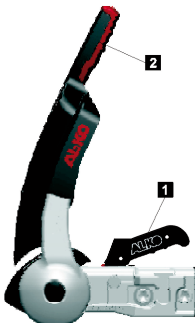
Fig. 5 : Dispositif d'attelage ouvert
